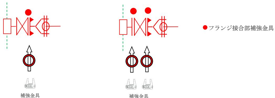
※耐震管路、一般管路にかかわらずフランジ接合部補強金具 (7.5K) ブロック形を施工する。
