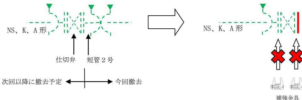
※既設管を撤去する工事で、今回は短管 2 号まで撤去し、次回以降で仕切弁から引き続き既設管を撤去していく予定。
